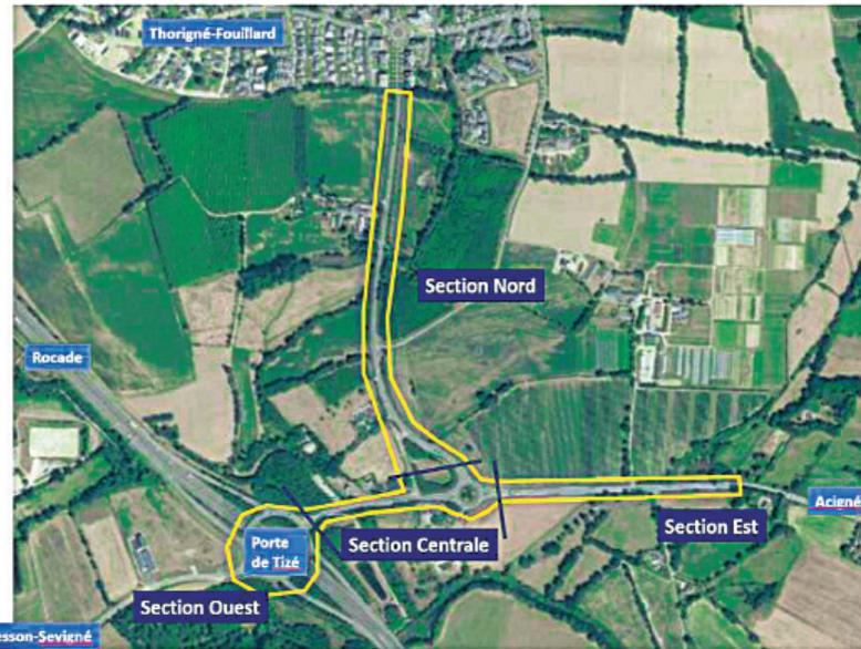
la section centrale sera optimisée en largeur pour rester dans le gabarit du pont existant tout en permettant une circulation sécurisée de tous les moyens de locomotion dans un souci de sécurité optimale (bus, voiture et vélo).
