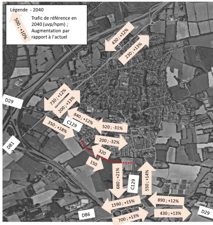
Figure 43 : Trafic attendu à l'heure de pointe du matin en situation de référence en 2040 et évolution par rapport à l'actuel
